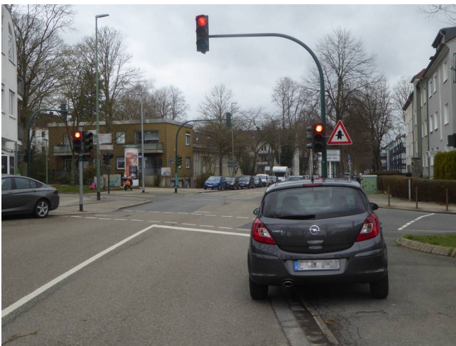
Bild 31: Durchgezogene Linien als Fahrbahnrenner erzeugen ein Parkverbot vor einer Ampel, da andere Fahrzeuge sie nicht überfahren dürfen.
