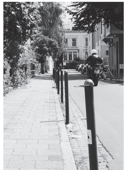
Abbildung 5 Poller am Fahrbahnrand zum Schutz vor Gehwegparken
