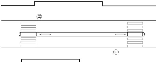
**Abbildung 9** An Bushaltestellen ermöglichen Fußgängerüberwege in Verbindung mit Mittelinseln eine sichere Fahrbahnquerung
