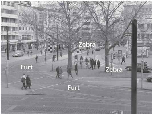
**Abbildung 7** Lichtsignalanlagen und Fußgängerüberwege können auch bei geringen Abständen sicher und sinnvoll sein
