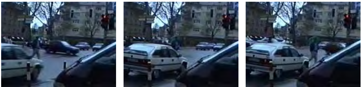
Abb. 5: Kollisionskurs eines sich schnell annähernden Grünpfeil-Nutzers vor einem bei Fußgängergrün querenden Fußgänger; Nothalt des Grünpfeil-Nutzers (dieser Grünpfeil wurde inzwischen entfernt).
