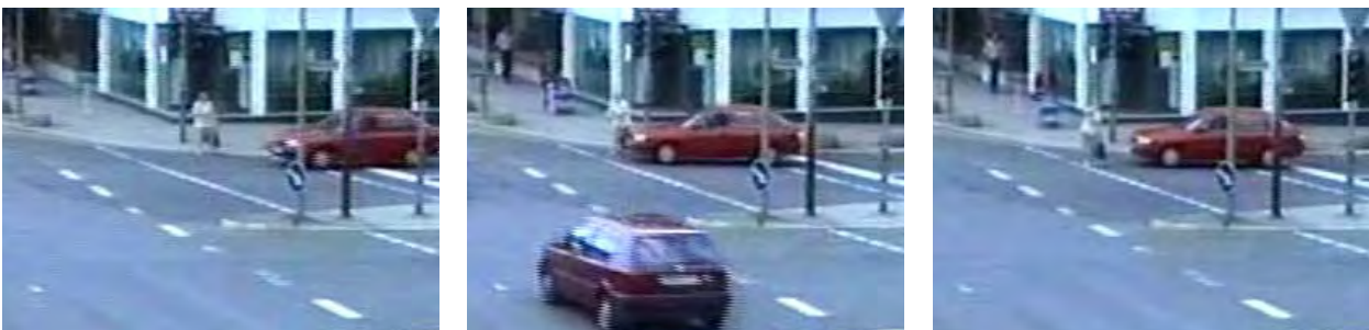
Abb. 3: Kollisionskurs eines langsam die Haltlinie überfahrenden Grünpfeil-Nutzers auf eine Seniorin, die zur Querung angesetzt hat; Notstopp der Seniorin und Nothalt des Grünpfeil-Nutzers.
