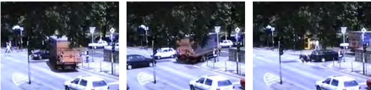
Abb. 27: Massive Behinderung des bevorrechtigten grünsignalisierten Kfz-Querverkehrs von links durch einen Grünpeil-Nutzer (langes Fahrzeug).
